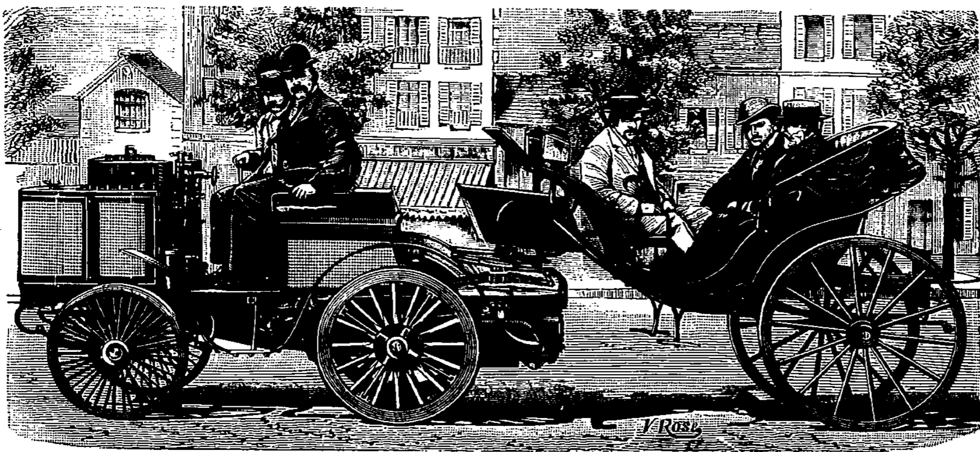
TRACTEUR DE DION-BOUTON A LA DIRECTION, MM. DE DION ET BOUTON (La France Automobile)
