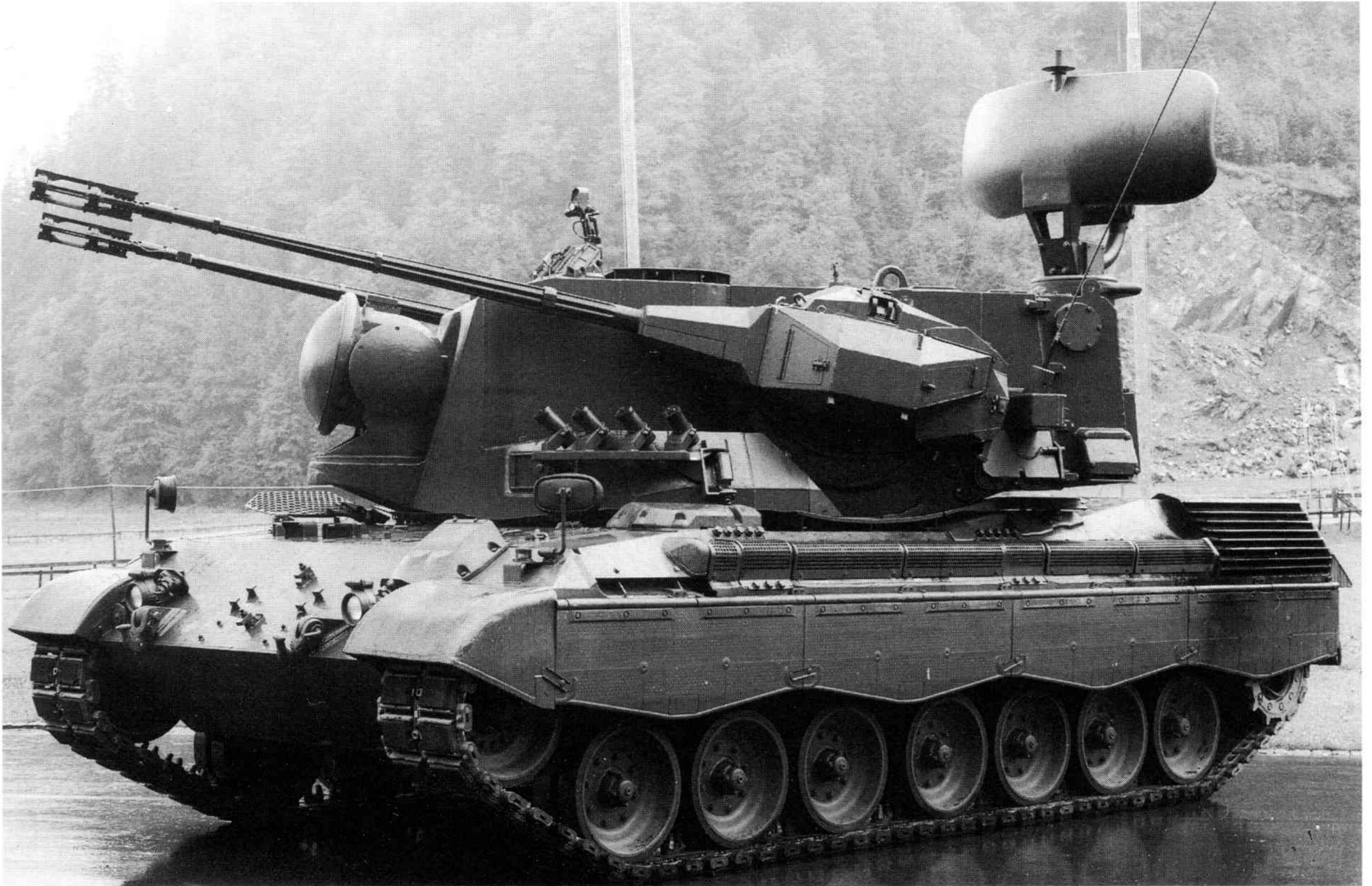
Flakpanzer Gepard (two 35mm Oerlikon KDA) (Courtesy: Ian Hogg)
